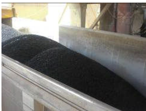
Foto 10. Bañera con MBTE. Ausencia de humos
