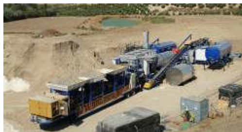
Foto 3. Planta FAMAT – 135 diseñada específicamente para mezclas templadas
