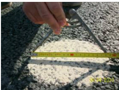
Foto 16 Control de la macrotextura de una MBTE
